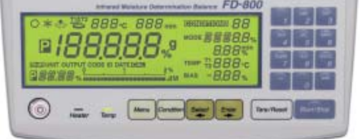
FD-800の表示部と操作スイッチ。撮影のためLCDを全表示にしています。実際の使用時とは異なります。
