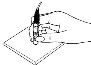
プローブを測定面に垂直に当たるように、すばやく押し下げます。
