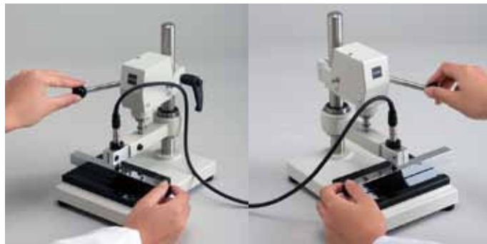
●昇降レバーは取り付け位置を、左から右に変更することが可能です。
