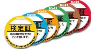
ケツトのライスタは、アフターサービス体制が確立しています。機械や水分計は使用前の点検と調整が必要です。特に水分計は見た目だけでは、正しい水分が測定できるかどうか分かりません。このためケツトは毎年、全国規模でアフターサービスの点検調整を行い、点検済みのライスタには上のような検定証を貼っています。
