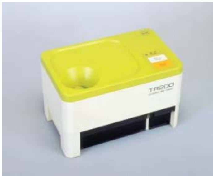
TR-200は電気抵抗式米麦水分計の、玄米試料を作成するための電動式もみすり器です。操作は極めてカンタンで、ボタンを押して、もみをホッパーに入れるだけです。わずかな時間でもみすりを行い、もみがらと玄米をあざやかに分離します。1回当たりのもみすり量は約20g。農業試験場、研究室、そしてライスセンターなどの農業施設での水分測定や、水分検査の補助機器としてお備えいただきたい1台です。
