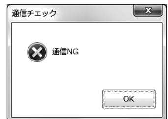
\* 「通信NG」と表示された場合は、通信ケーブルの接続、結線、断線、COMポート番号などを確認し、再度チェックしてください。
