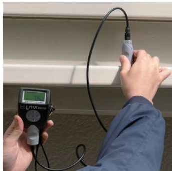
Feプローブとプローブ接続ケーブルでの測定。
