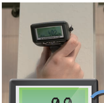
ワイヤレスデュアルプローブでの測定。測定値は無線で本体へ送信されます。
