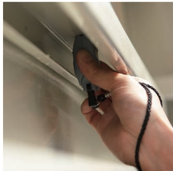
ワイヤレスデュアルプローブでの測定。測定値は無線で本体へ送信されます。
