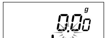
⑤ 内部質量計のゼロ点表示「0.0g」が表示されたら、200g標準分銅を中筒にかぶせた試料カップの上に静かに載せます。
