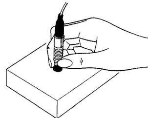
プローブを測定面に垂直に当たるように、すばやく押し下げます。
